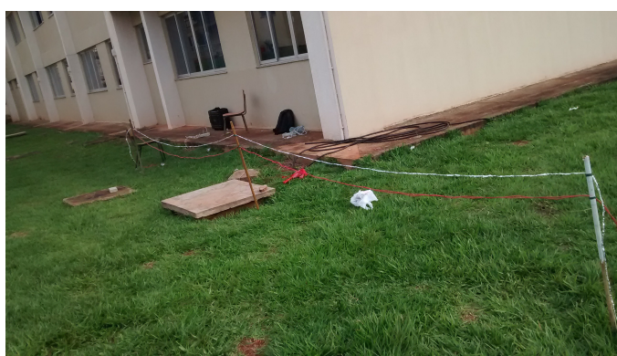
Figura 11 – Cabo sem blindagem (vermelho) e cabo blindado.
