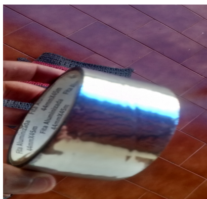
Figura 6 – Fita aluminizada: 45m x 44mm x 40 \mu m.
